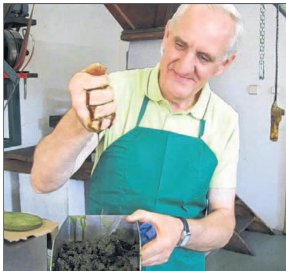
Frisch aus der Mühle: Siegfried Fürpaß demonstriert von Hand, wie man Öl aus einem Brei von Kernen, Zucker und Wasser presst. Bilder: pbs (3)
